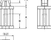
タッピンネジ用下穴 φ 2.9 (使用ビス 呼び径3.5)
